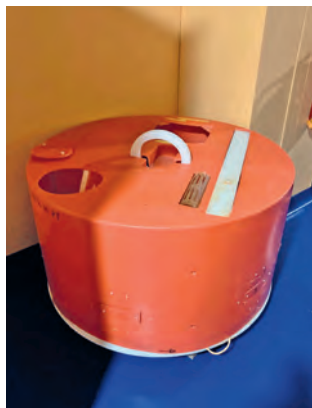
Estação sísmica para o fundo do oceano, concebida e executada no Instituto Dom Luiz – Faculdade de Ciências – Universidade de Lisboa
